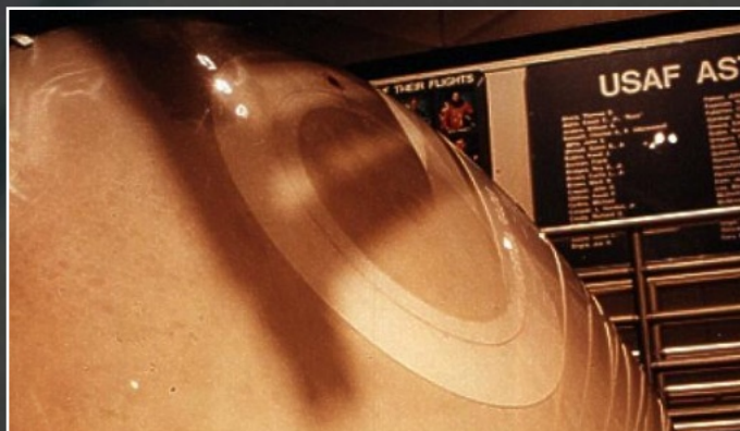
Osłona cieplna kapsuły Gemini B użytej w testach widoczny uchylny element służy (Peter Bednar / Encyclopedia Astronautica)
