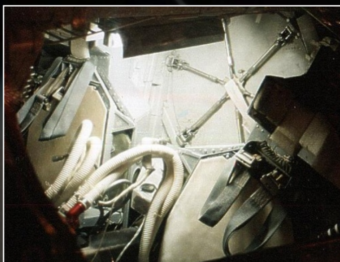
Wnętrze Gemini B z widocznym włazem w dolnej części kapsuły. (Peter Bednar / Encyclopedia Astronautica)
