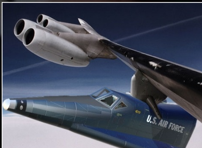
Wizja artystyczna lotu testowego X-20 podczepiony pod skrzydłem bombowca B-52 (Dan Roam)
